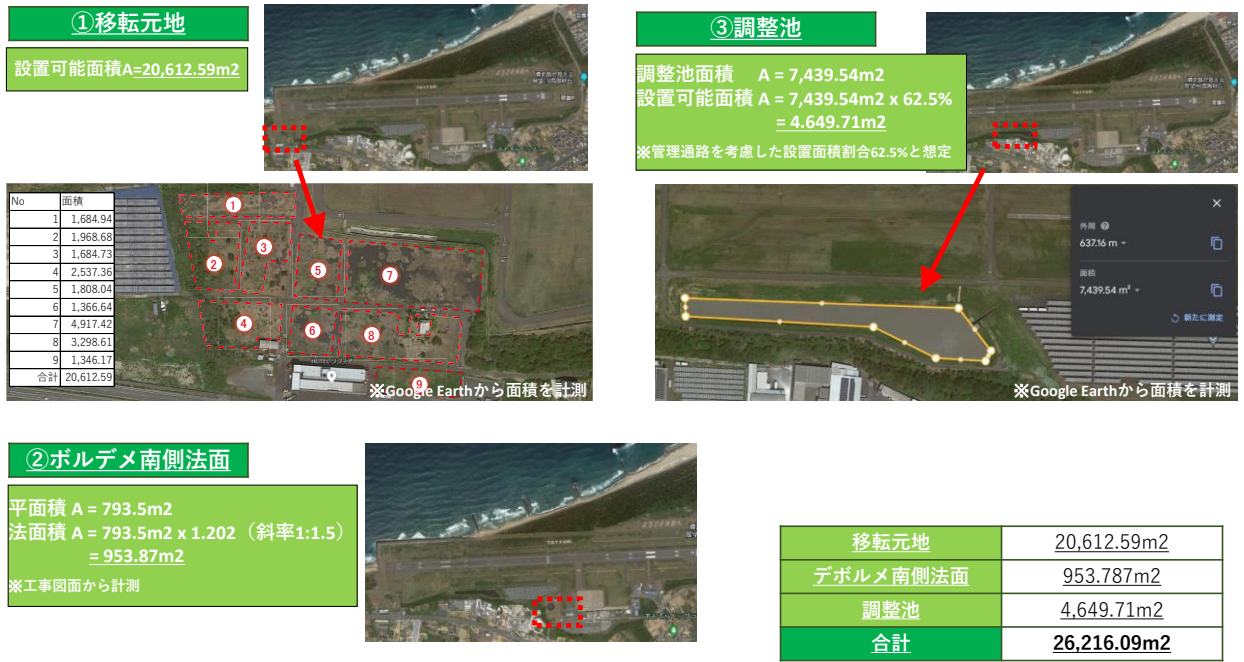
図 C-17 太陽光発電設置候補内の面積
